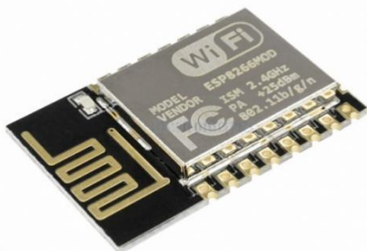
Fig., 4 Wi-Fi Module ESP-12E
