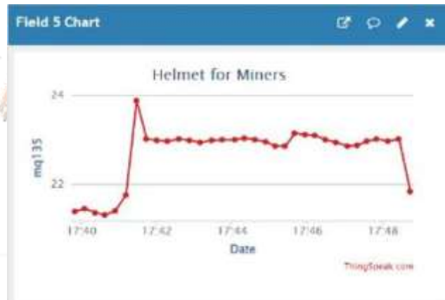
Fig 8 MQ135 Gas sensor measurement
